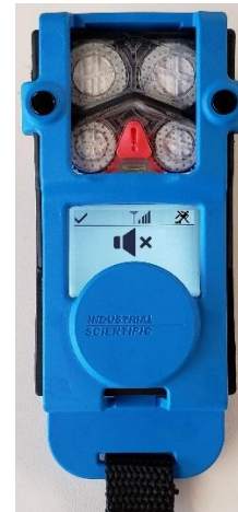
Ventis Pro avec Standby Clip (Homme à terre et mesures de gaz en veille)
