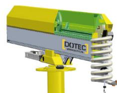
La pression d'air comprimé qui déplace le piston amène la charge «en équilibre». Le piston se déplace en laissant entrer et sortir de l'air comprimé. La tige de piston est reliée à une vis à billes qui est reliée à la bobine. De cette manière, le mouvement linéaire du piston est transformé en un mouvement de rotation de la bobine. Cela signifie que le câble métallique s'enroule et se déroule. La charge est donc soutenue en permanence par un coussin d'air.
