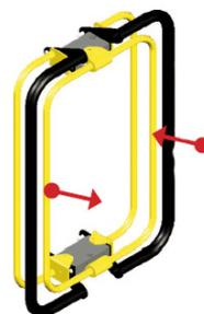
Activée par la poignée ergonomique, la commande permet à l'air comprimé de pénétrer dans l'équilibreur pour le déplacement vers le haut / vers le bas. Les vannes réagissent «proportionnellement», ce qui signifie que «presser» le levier de commande plus fort entraîne un mouvement plus rapide vers le haut et vers le bas. Cela rend le fonctionnement de l'ascenseur rapide et précis, quelque soit le mode d'exploitation.
